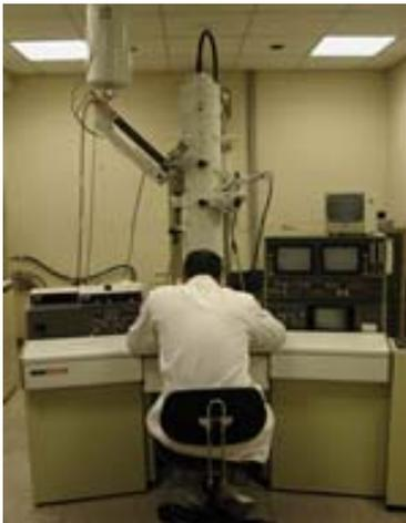
Microscopio electrónico de transmisión perteneciente al SCCYT (UCA), de filamento termoiónico de wolframio. Permite la aceleración de electrones hasta 120 kV; dedicado principalmente a CTEM. Cuenta con un goniómetro de entrada lateral de doble inclinación ( $\pm 60^\circ$ ).
