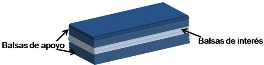
**Figura II.2:** Esquema de las balsas en una preparación de muestras mediante XTEM.
