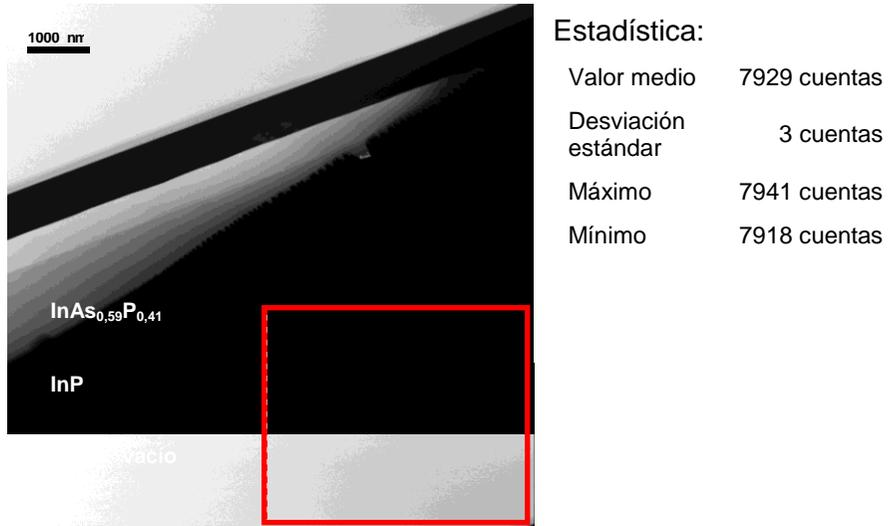
**Figura III.2:** Imagen HAADF de la muestra C59, donde se muestra una zona amplia sin muestra (en negro). En la tabla insertada aparecen los valores estadísticos de la intensidad de los píxeles de la zona delimitada por el rectángulo rojo.
