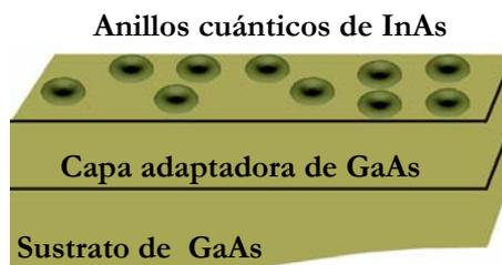
**Figura IV.2.1.1:** Esquema de la capa simple de anillos cuánticos de InAs (muestra SR).
