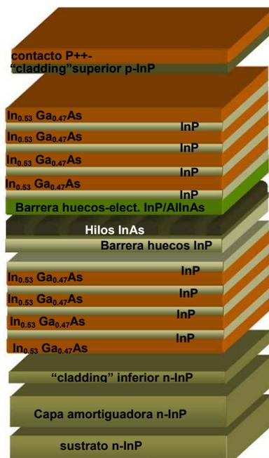
Figura V.2.1.1: Estructura láser.
